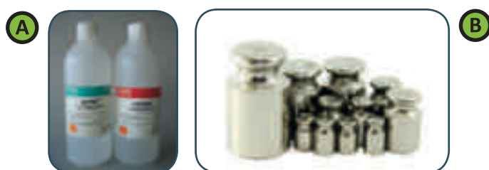
Figura 3 – Soluções de calibração para medidores de pH (A); massas padrão (B).
